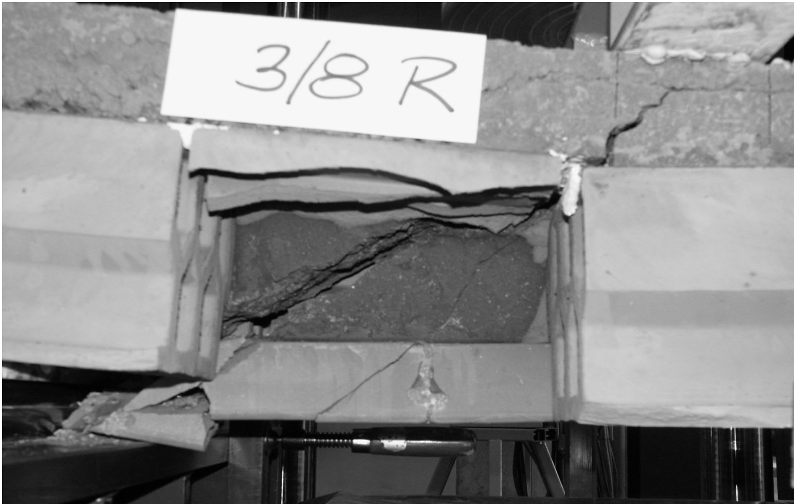
typischer Versagensmodus, Riss kreuzt Fuge
