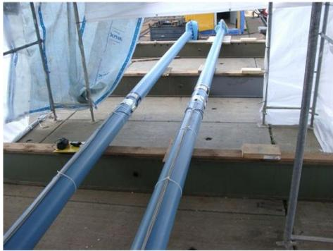
Bild 2: mit Dehnungsmessstreifen applizierte Zugstangen der Klappbrücke
