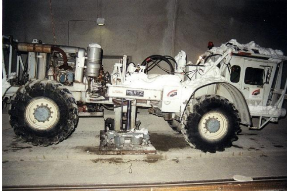
Bild 2: VibroScan®-Untersuchung im Tunnelbauwerk
