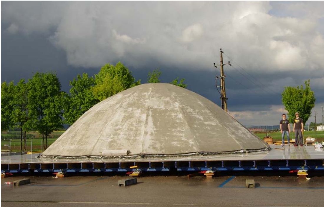
Abbildung 1 Großversuch an einer rotationssymmetrischen Betonschale mit 13m Durchmesser und 3,2m Höhe
