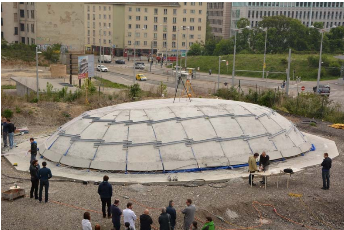
Abbildung 1 Großversuch an einer Freiformschale mit Endabmessungen von 17,6x10,8m und einer Höhe von 2,9m
