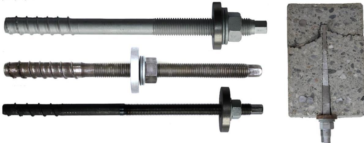
**Bild 1. Betonschrauben mit großem Durchmesser, welche in den durchgeführten Versuchsreihen als Querkraftverstärkung eingesetzt wurden (links) und Betonschraube eingebaut im Versuchskörper (rechts)**
