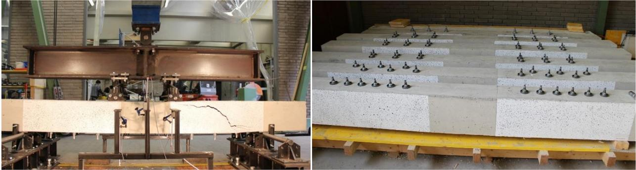
**Bild 2. Versuchsaufbau und verschiedene Konfigurationen der Betonschrauben in den Versuchsträgern**
