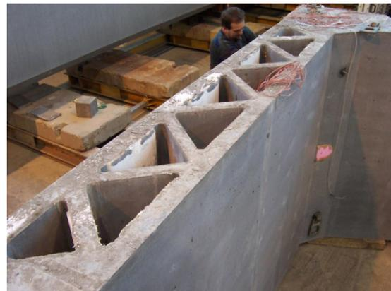
Das Planschleifen der Kontaktflächen erfolgte mittels eines patentierten Verfahrens seitens der Fa. Bögl.
