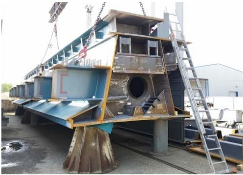
Die Hauptträger sind durchgehend als Stahl-Hohlkästen in einer Sonderform ausgeführt, wobei die Bauhöhe von den Lagerpunkten zu den Koppelstücken abnimmt, so dass diese Bereiche vergleichsweise weich sind. Die Gehwegkonstruktionen sind ebenfalls als Stahl-Hohlkästen konzipiert und tragen in Brückenlängsrichtung entsprechend der mitwirkenden Plattenbreite mit.
