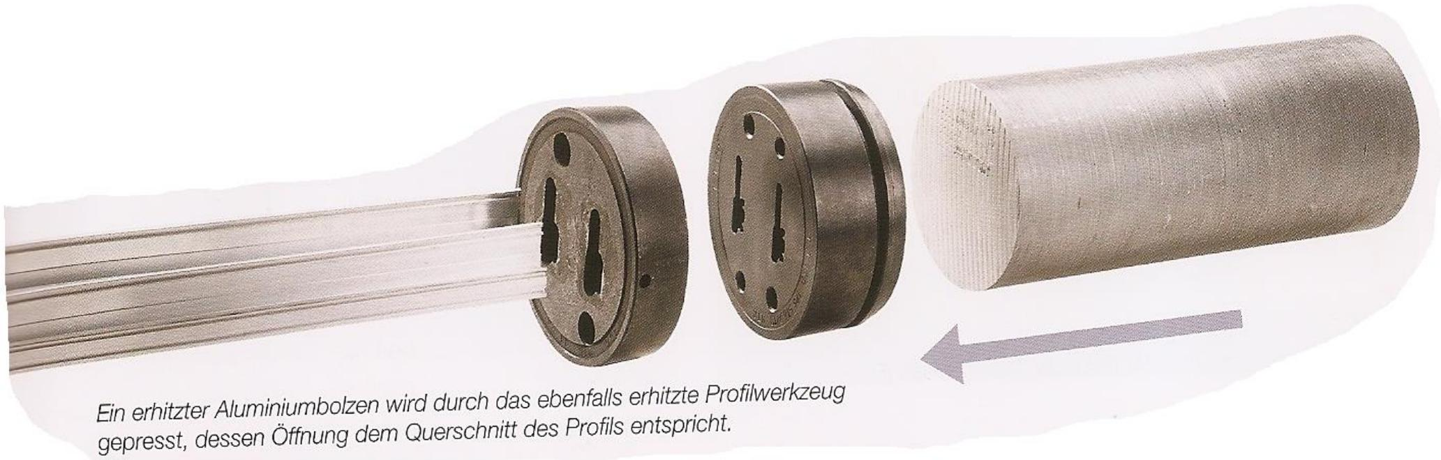
*Ein erhitzter Aluminiumbolzen wird durch das ebenfalls erhitzte Profilwerkzeug gepresst, dessen Öffnung dem Querschnitt des Profils entspricht.*
