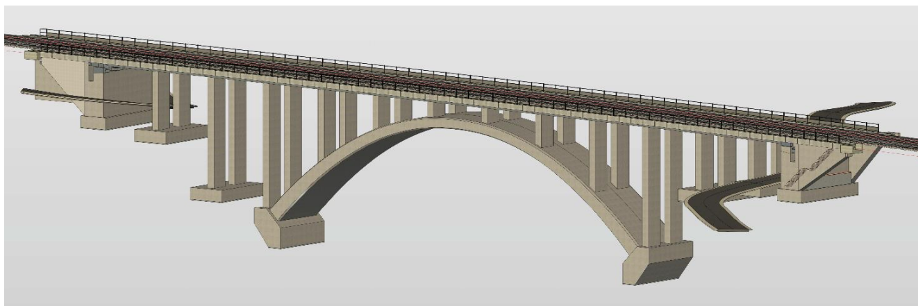
Abb.2 REVIT-Modell der neuen Schalchgrabenbrücke
